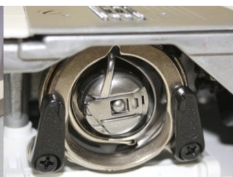
Celokovová konstrukce čapače
